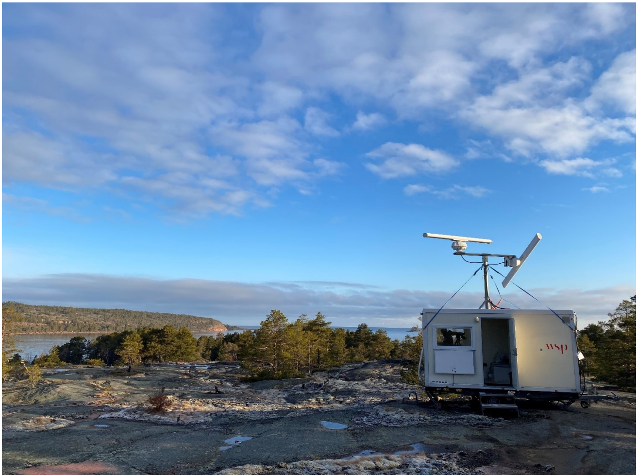
Figur 2. Uppställning av fågelradarstation vid Dånö, Långnäs på Ålands norra sida. Utrustningen består av en horisontell och en vertikal radar monterade på en släpvagn. Den horisontella radarn används för att bestämma flyttfåglars flygriktning, medan den vertikala radarn används för att bestämma flyghöjd och migrationsintensitet.
