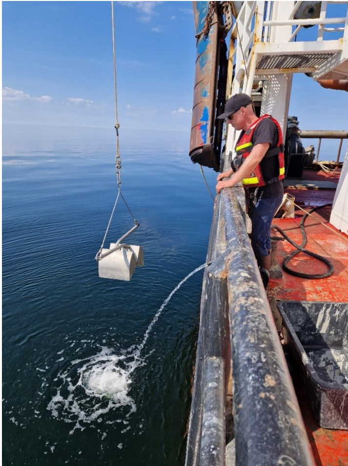
Figur 4. Provtagning av bottenhugg med Van Veen-huggare.
