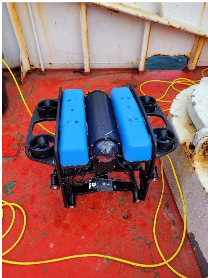
Figur 3. ROV (BlueROV2) från Blue robotics som användes vid videoundersökningar.
